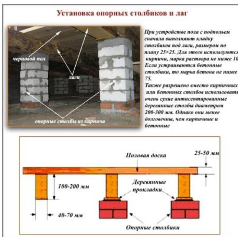
Установка опорных столбиков и лаг
